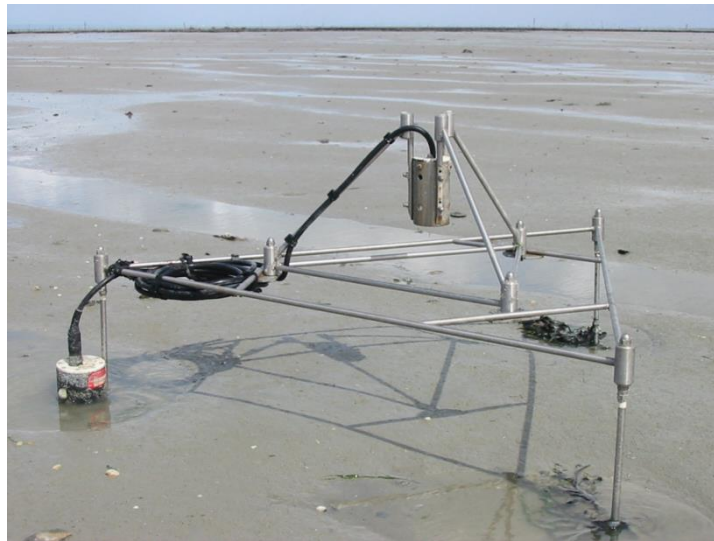
Illustration 1 : Capteur Altus NKE installé sur son trépied sur un estran. Le cadre triangulaire présenté ici est plus large que le cadre utilisé pour cette campagne.
