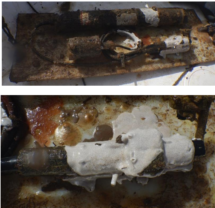
Illustration 30 : Etat de salissure du mouillage et du capteur de turbidité le 28/04/17 après 6 semaines.
