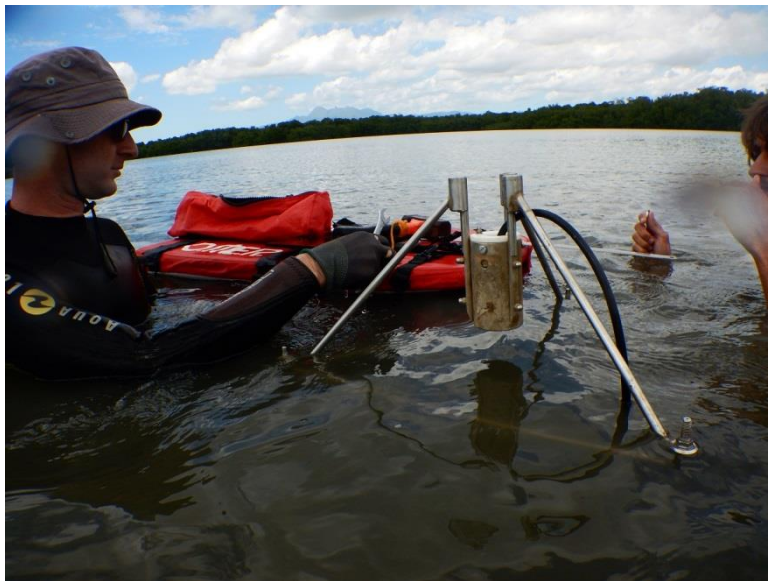
Illustration 3 : altus 3 les pieds équipés d'hélices sont enfoncés simultanément par vissage
