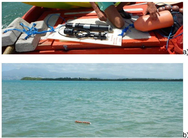
Illustration 29 : Image du mouillage et du capteur avant mise à l'eau (a). Vue de la surface après mise à l'eau (b).
