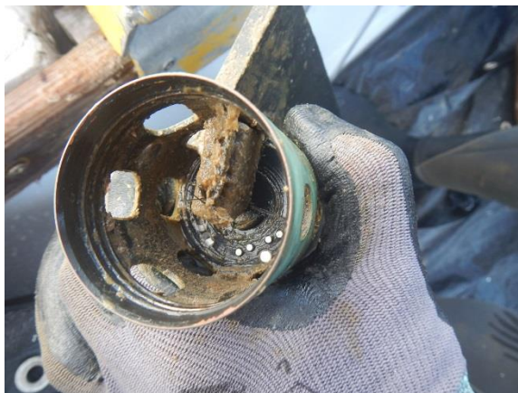
Illustration 45 : Forte salissure d'origine biologique sur les capteurs et le balai de nettoyage de la sonde multiparamètre Aquatroll.
