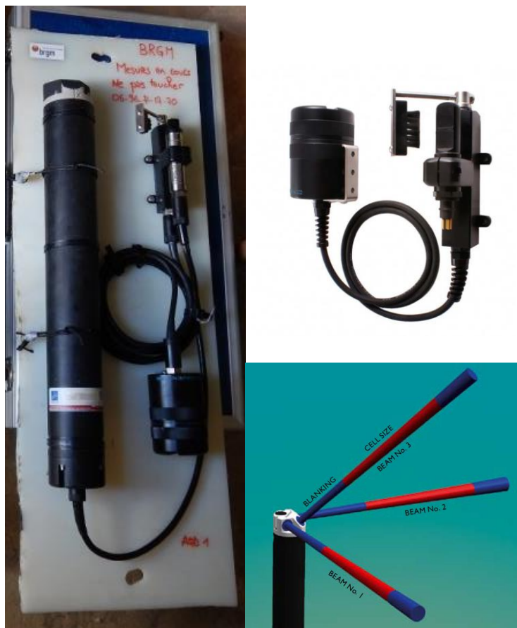
Illustration 23 : Installation du système de mesure de la turbidité, détail sur le capteur de turbidité OBS3+ équipé d'un balai de nettoyage automatique et sur le principe de mesure ponctuelle du courant par effet Doppler de l'Aquadopp Nortek.
