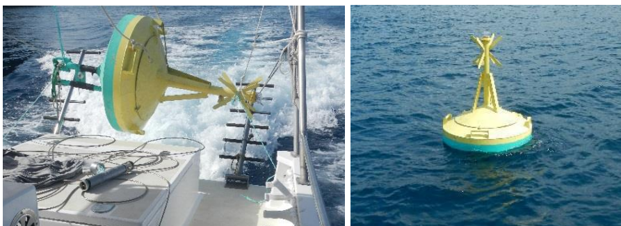
Figure 5. Ligne de mouillage 1 à proximité du point 1 et bouée de signalisation en surface.
